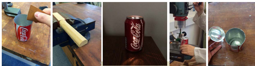
Figura 6 – Sequência de imagens descrevem execução de luminária com lata de Coca-Cola Fonte: Blog Homens da Casa (2015).
